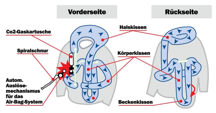
Einmal aktiviert bleibt das Gas ca. 10 Sekunden vollständig in der Weste, bis es langsam anfängt, aus dem Ventil zu entweichen. Nun kann die Gaskartusche entfernt werden und das Gas entweicht vollständig, wenn man die Luftkissen wieder zusammendrückt.
