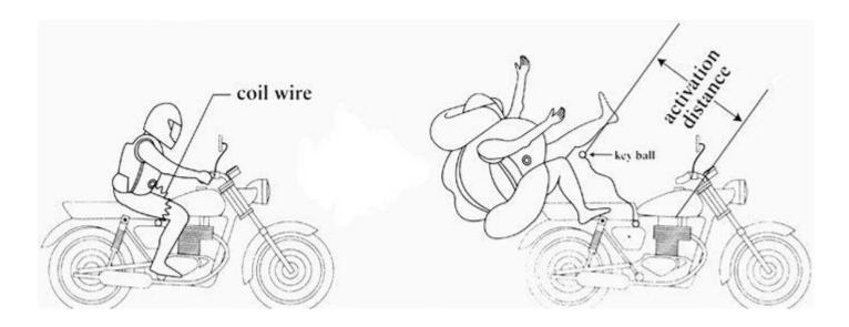
Erst wenn der Fahrer vom Bike getrennt wird, aktiviert die Spiralschnur die Hit Air Weste/Jacke. Der Aktivierungsabstand ist erreicht und innerhalb des Bruchteils einer Sekunde ist das schützende Luftpolster entfaltet. Der Nackenbereich, der Oberkörper und das Steißbein werden gepolstert. Das Becken- und Halskissen klappen automatisch heraus. Die Hit-Air Jacken verfügen zusätzlich über klassische Protektoren für Schulter und Ellenbogen.
